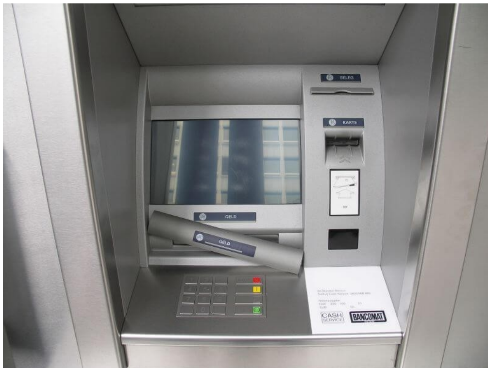
Камера в фальш-панели под экраном:
