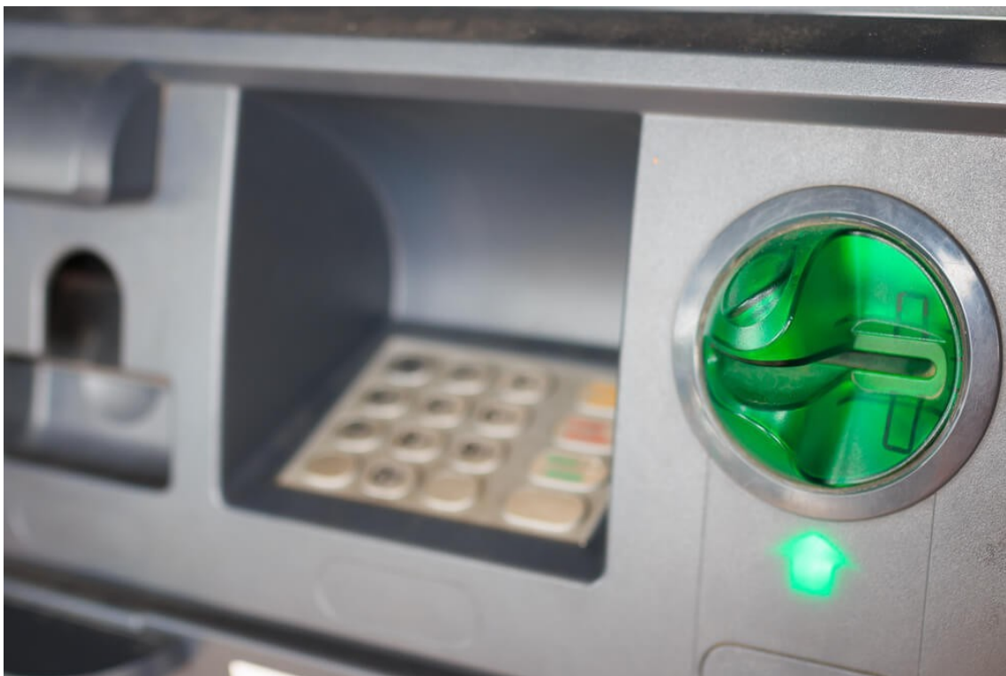
Антискиммер – защитная накладка на картоприемнике банкомата
