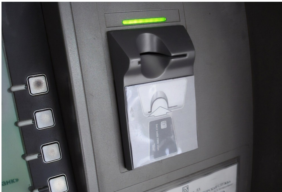
Установленный на картоприемник скиммер
